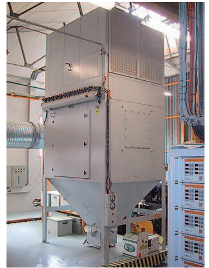
Un dels filtres absoluts de partícules de pintura en pols de les línies de pintura.
